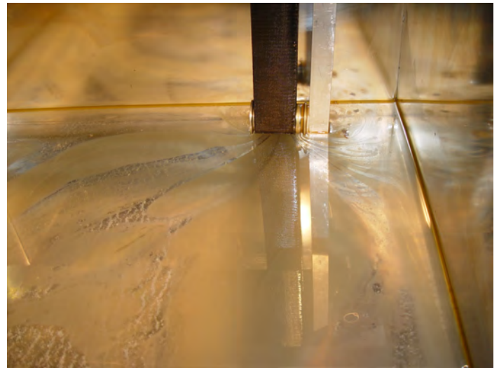
Die aufschwimmende Ölphase wird angezogen
